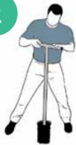
Vissez le plot de fondation totalement dans le sol à l'aide du tournevis HAPAX®.
