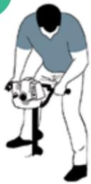
Pré-percez à l'aide d'une tarière d'un diamètre de 10 -12 cm.
